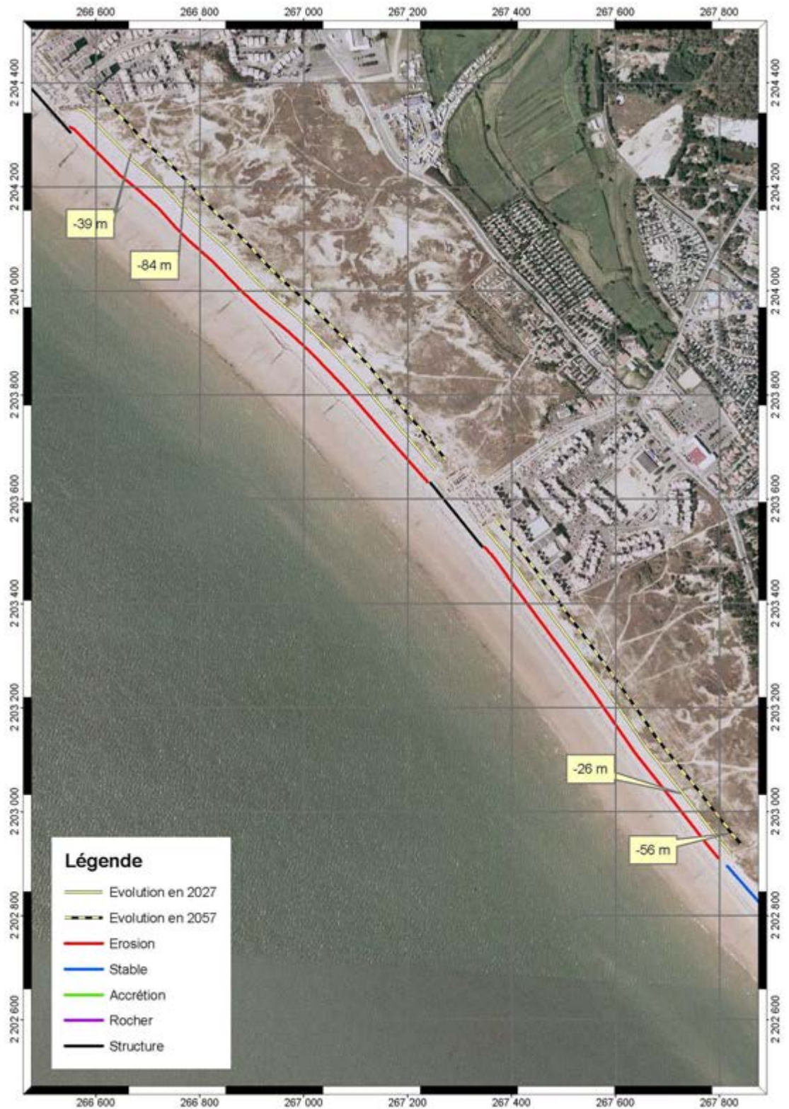
Figure B.3.35 Scénario d'évolution du trait de côte des plages des Becs et des Mouettes à court terme : localisation du trait de côte en 2001 et 2027..
