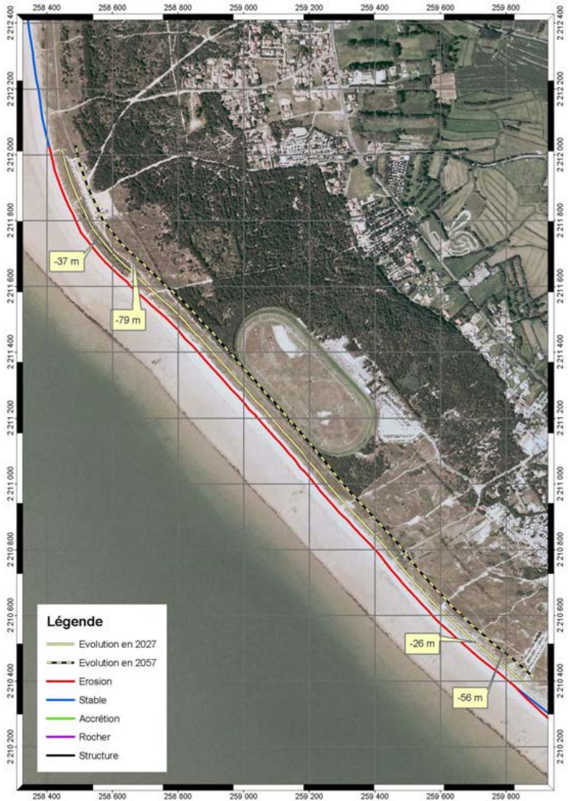
Figure B.3.31 Scénario d'évolution du trait de côte du Pont d'Yeu à la plage de la Tonnelle à court terme : localisation du trait de côte en 2001 et 2027..
