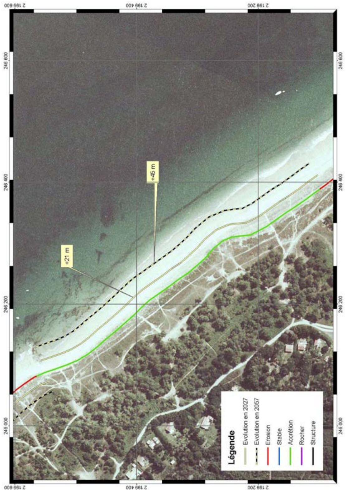
Figure B.4.13 : Scénario d'évolution du trait de côte la plage des Ovaire à court terme : localisation du trait de côte en 2001 et 2027.
