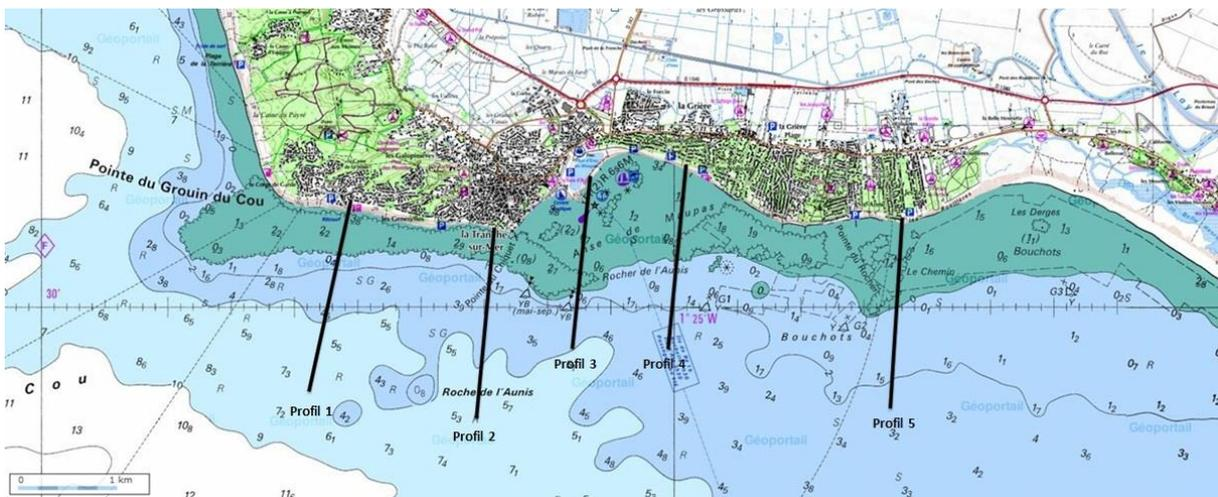
Figure 4-18 : Présentation des différents profils de propagation des conditions de mer du large vers la côte
